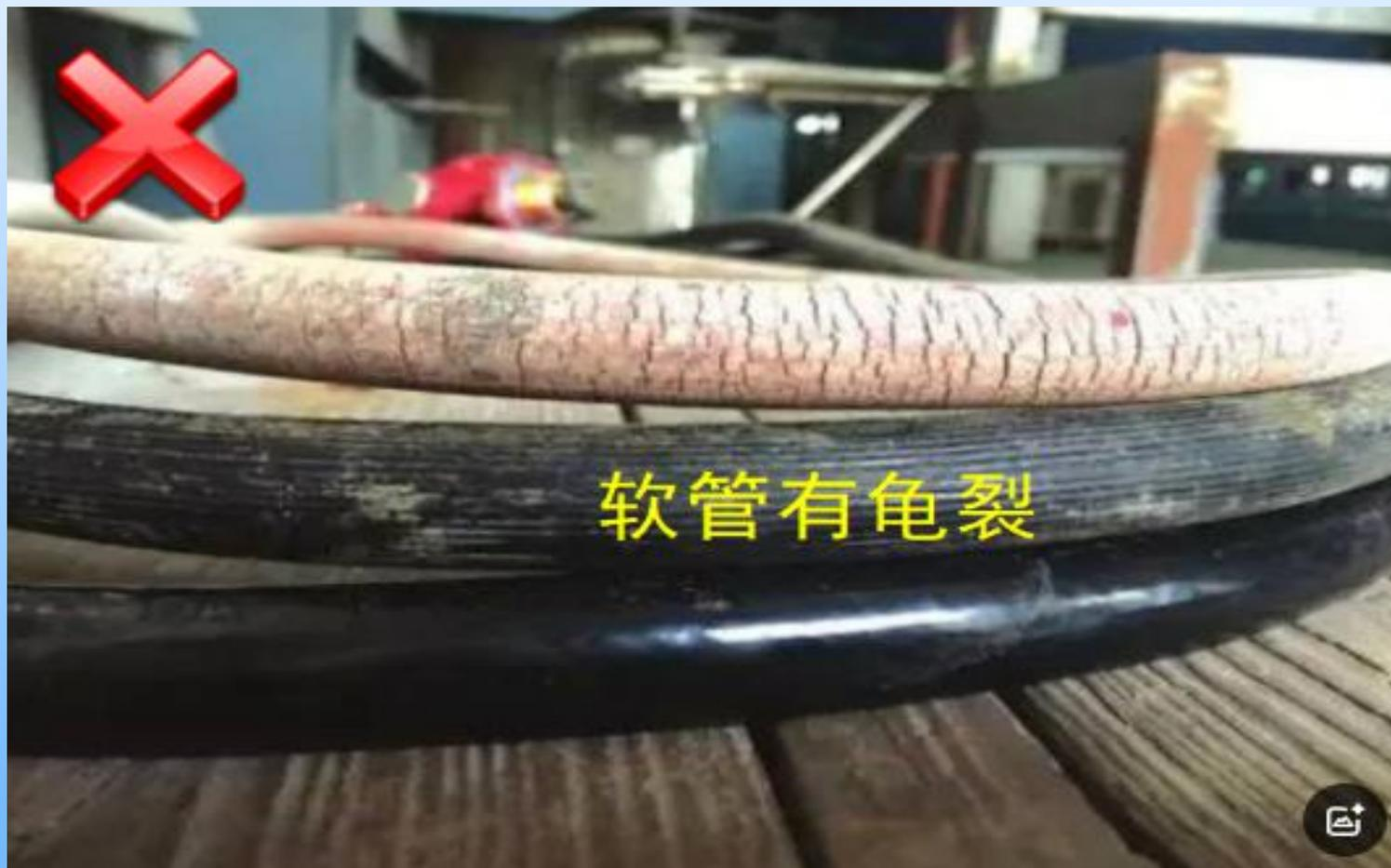
依据：《城镇燃气设施运行、维护和抢修安全技术规程》CJJ51-2016第7.8条规定
